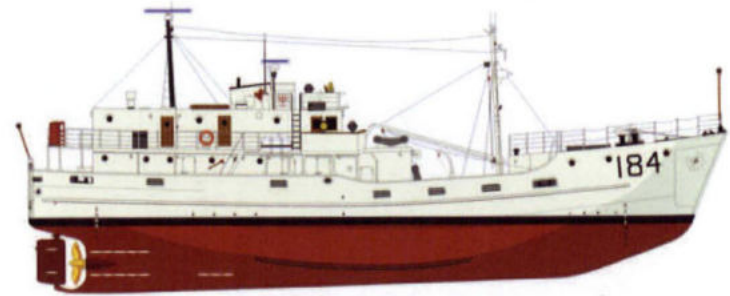
Porte Class HMCS Porte de la Reine 429 tons - 38.3 m x 8.1 m x 3.9 m - 11 kt
