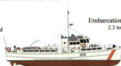
Classe YAG de 75 pieds YFB-320 81 tonnes - 22.9 m x 5.6 m x 1.2 m - 11 nd
